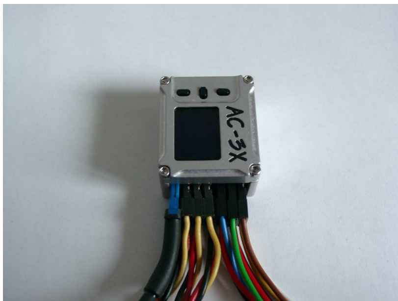
Figure 8 : AC-3X avec les câbles de connexion au récepteur et les 4 servos branchés
