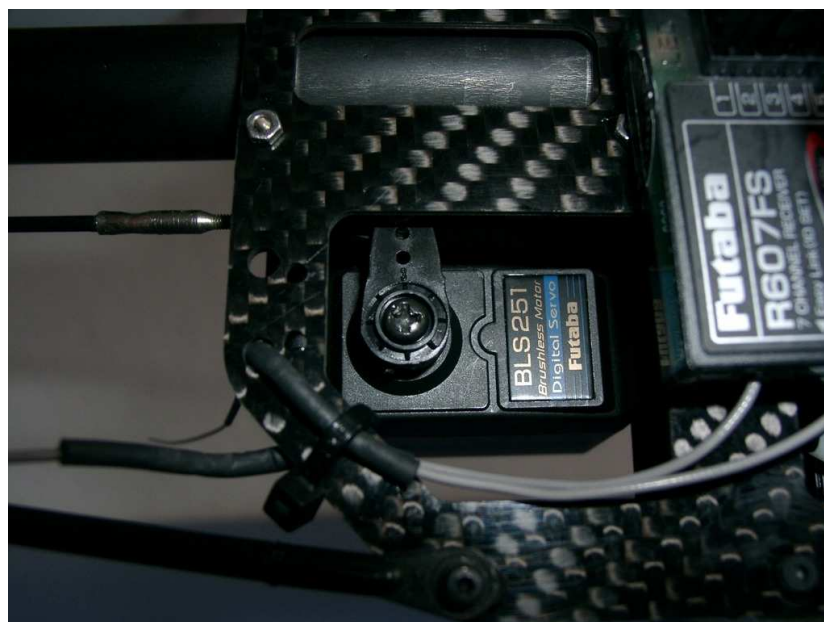
Figure 13 : orientation du palonnier de servo d'anticouple
