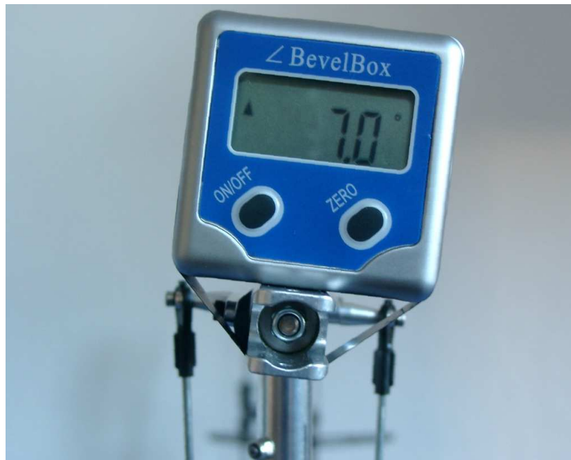
Figure 16 : Débattement maxi au cyclique de 7 °
