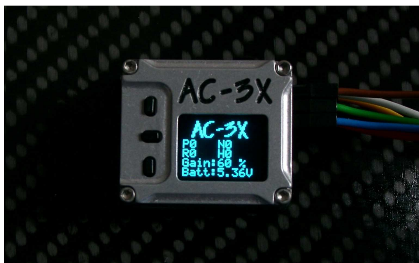
Figure 12 : AC-3X réglé à 60 % de gain
